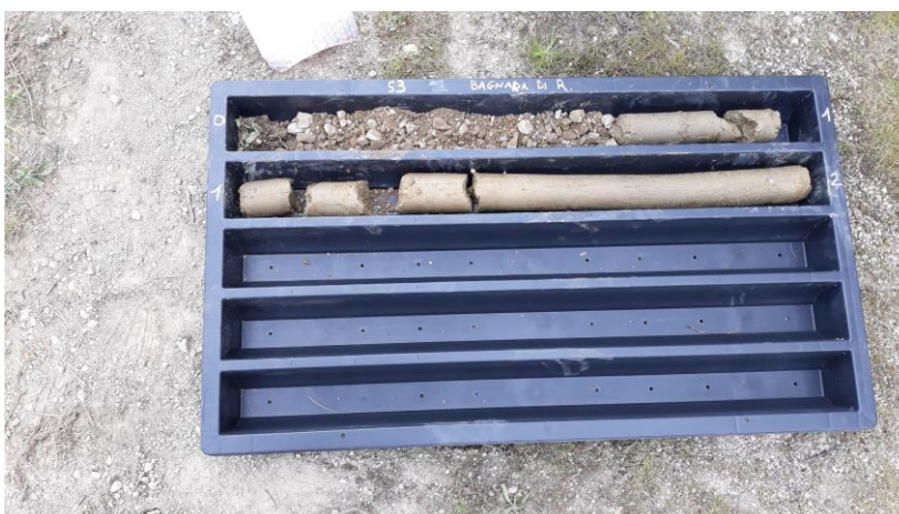
Figura 10 – sondaggio S3, cassa 0-2m
