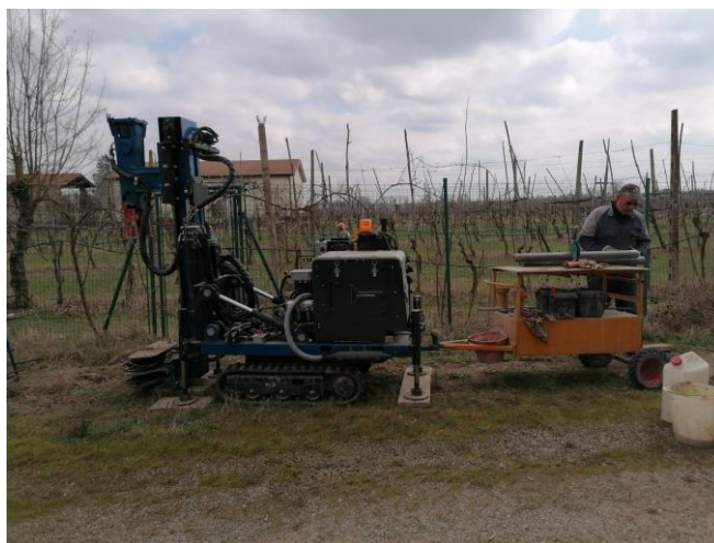
Figura 9 – sondaggio S3, piazzamento sonda
