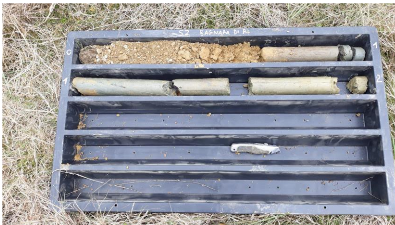
Figura 8 – sondaggio S2, cassa 0-2m
